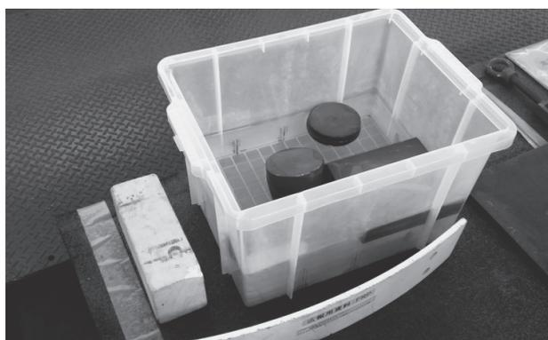
写真3 「しんかい6500」船体素材、浮力材、鉄板など
