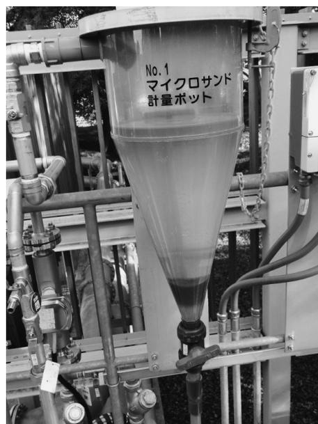
写真3 計量ピットで分離されたマイクロサンド
